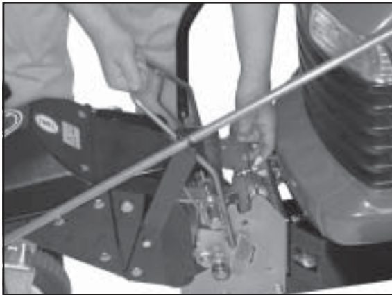
3) Schutz anheben und Kehrmaschine positionieren.
