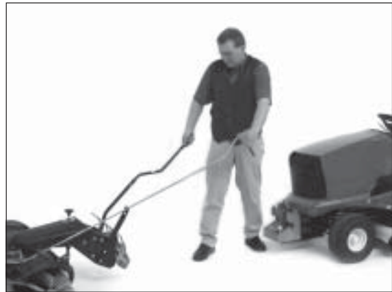
2) Kehrmaschine an den Rasentraktor heranziehen.
