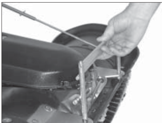
2) Verriegelung in hinterer Position.
