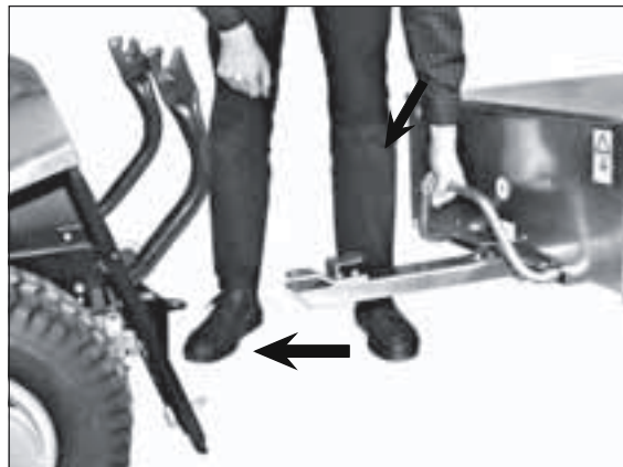
2) Anhänger auf die Anhängervorrichtung aufsetzen.
