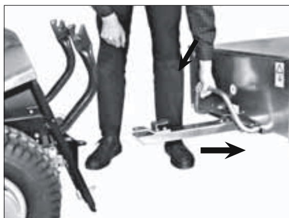
2) Anhänger von der Anhängervorrichtung ziehen.
