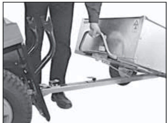
4) Beim Kippen des Kastenaufbaus immer in gezeigter Position anfassen.
