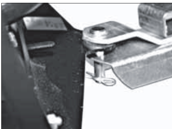
1) Bolzen und Federstecker entfernen.
