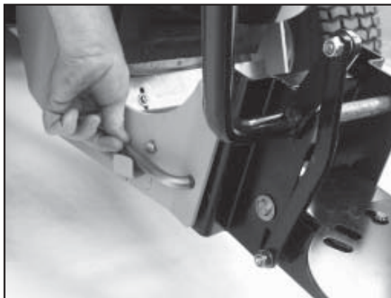
Bolzen durch die Bohrung von Schnellwechsler und Aufnahme schieben.
