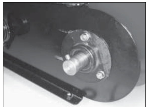
6) Zylinderstift und Welle von Schmutz befreien und einfetten.
