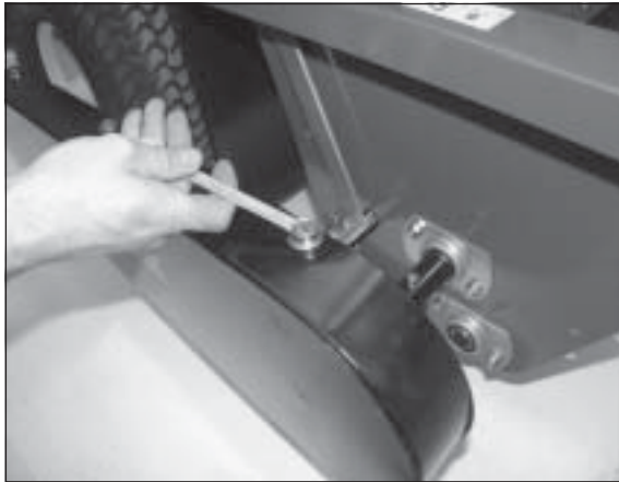
1) Schrauben am Schutzdeckel lösen.
