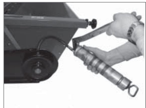
4) Schmiernippel mit Hilfe einer Fettpresseabschmieren.
