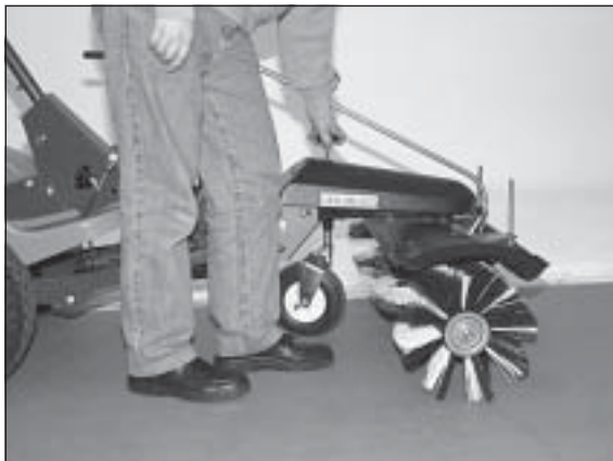
3) Senken Sie die Bürste so weit ab, dass sie gerade eben den Boden berührt. Dann noch 3 Umdrehungen entgegen dem Uhrzeigersinn in Pfeilrichtung (-) drehen.
