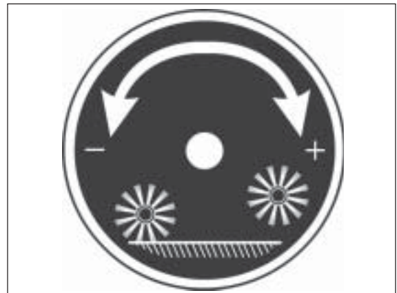
4) Drehen im Uhrzeigersinn (+) : Bürste anheben Entgegen dem Uhrzeigersinn (-) : Bürste absenken
