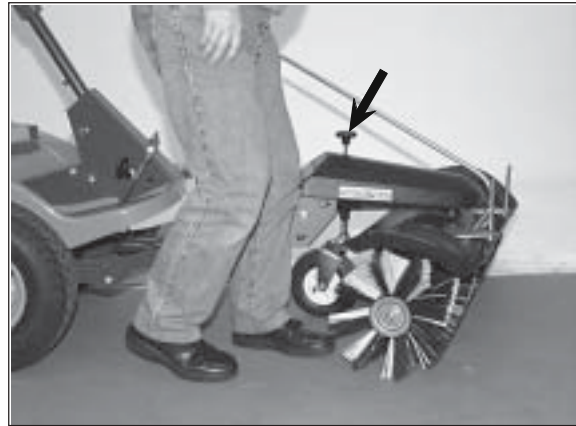
2) Der Bürstendruck läßt sich feinstufig einstellen. Das Stützrad ist deshalb in der Höhe verstellbar. Oberhalb des Stützrades befindet sich der Einstellknopf.
