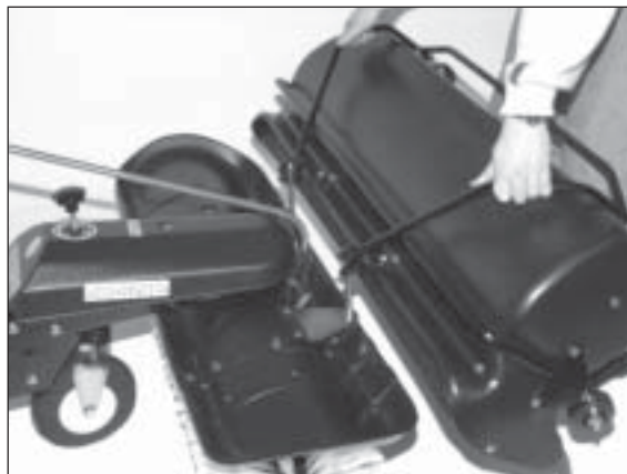
2) Kehrgutbehälter über die Aufnahmestangen halten.
