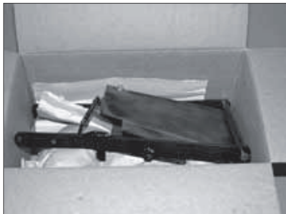
① Kontrolle der Originalverpackung (Anbaurahmen)
