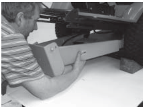
Den vormontierten Anbaurahmen auf die Vorderachse des Rasentraktors schieben.
