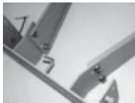
Den vormontierten Anbaurahmen auf die Vorderachse des Rasentraktors schieben.
