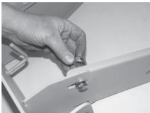
Mutter auf die Schraube drehen.
